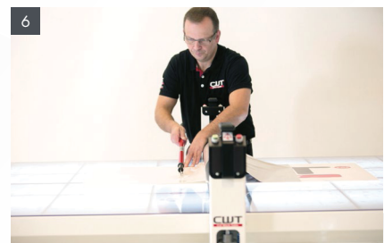
6 Elimine cualquier exceso de revestimiento.
